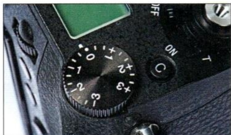
Per regolare l'esposizione, la RX10 presenta una ghiera selettiva sulla parte superiore. Praticissima.
