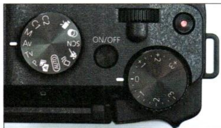
Sulla G3 X, tutto è a portata di mano: ghiera per le varie modalità e selettore per correggere l'esposizione.
