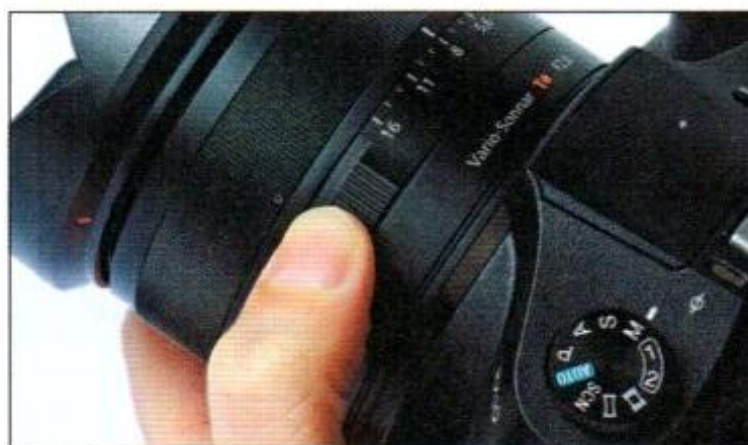
Un anello sull'obiettivo - come avveniva in passato - rende agevole selezionare l'apertura del diaframma.
